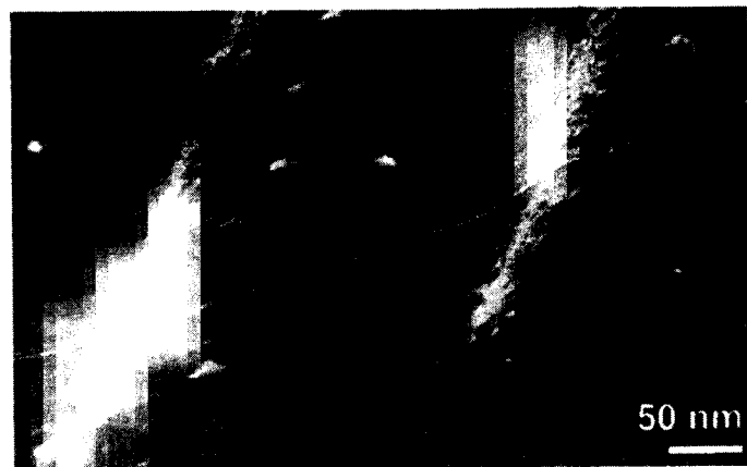
Рис. 4.18. Изображение в атомно-силовом микроскопе (простукивающий режим) однослойной нанотрубы, лежащей между Pt электродами на Si/SiO 2 подложке (4.42).
